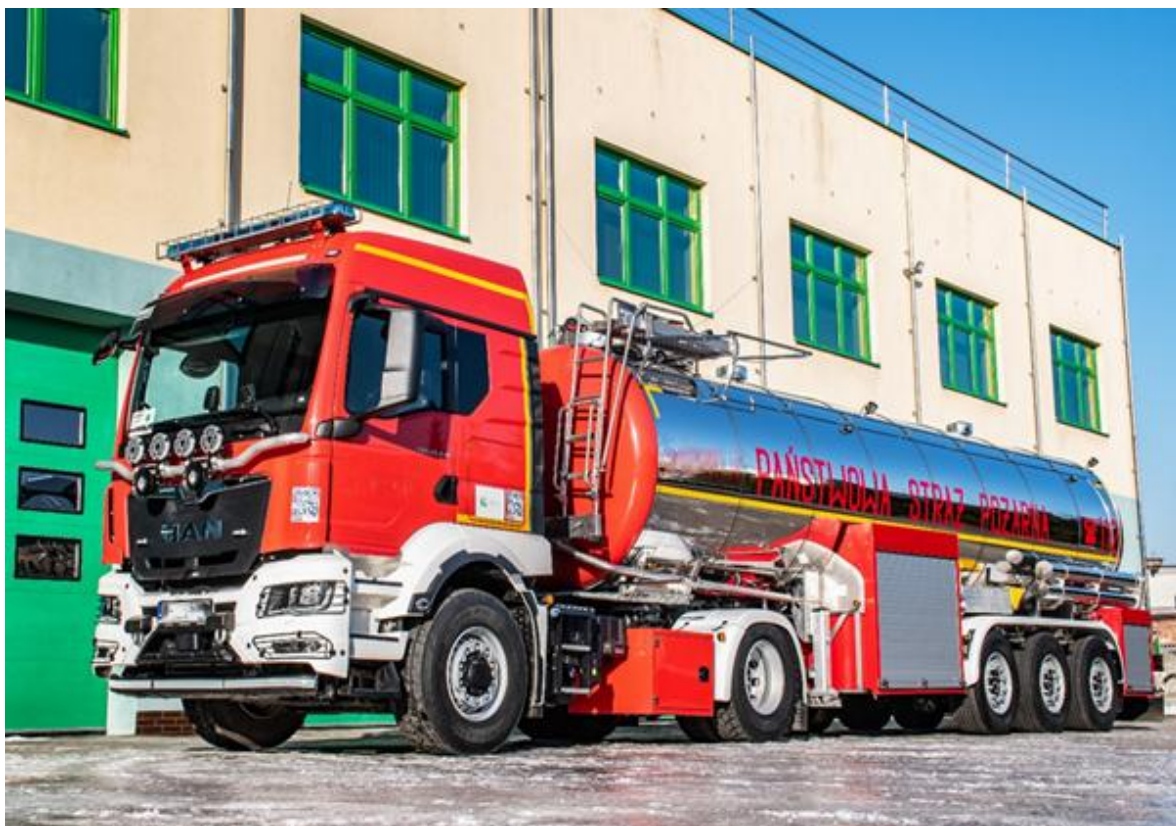
Zdjęcie nr 33. Ciągnik siodłowy Man TGS 18.440 wraz z naczepą specjalną (cysterną) oraz wyposażeniem.
